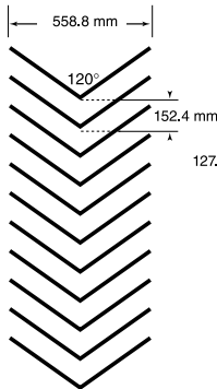
Plantilla #32 9.5 mm x 9.5 mm Chevrans Cerrados a 711.2 mm de ancho
