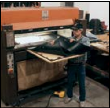
Corte mediante Matriz de Regla
